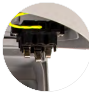
Desconexión directa en apertura
